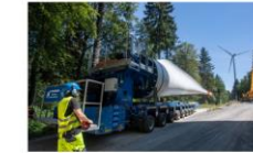
01 Die Anlageteile werden mit Tiefladern in Übergröße transportiert. Dazu ist bei einzelnen Kurven ein Ausbau notwendig.
